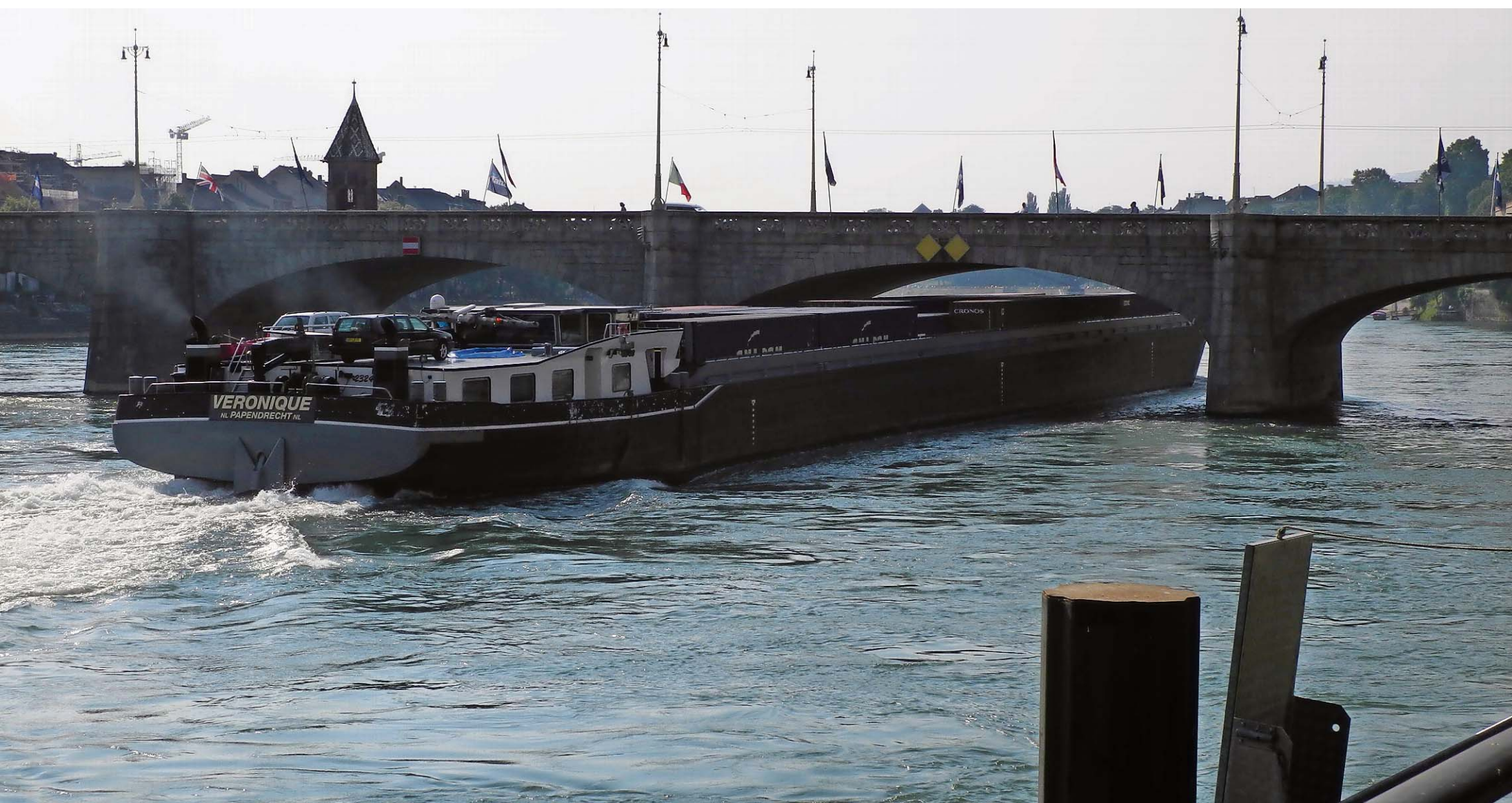
Schiff mit zwei Lagen Containern unter der Mittleren Brücke, zu einem Zeitpunkt, als diese bergwärts eine Durchfahrts Höhe von rund 6 Metern aufweist. Dabei ist nicht der Scheitelpunkt des Brückenbogens, sondern eine Durchfahrtsbreite von 17 Metern massgeblich. Die «Veronique» nutzt also die angegebene Durchfahrts Höhe weitgehend aus. BILDER: DPH
